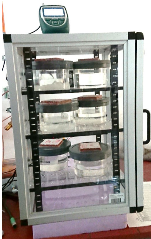
Abb. 5.6.1: Versuchsanordnung zur Dry-Cup-Messung im IBK-Labor
