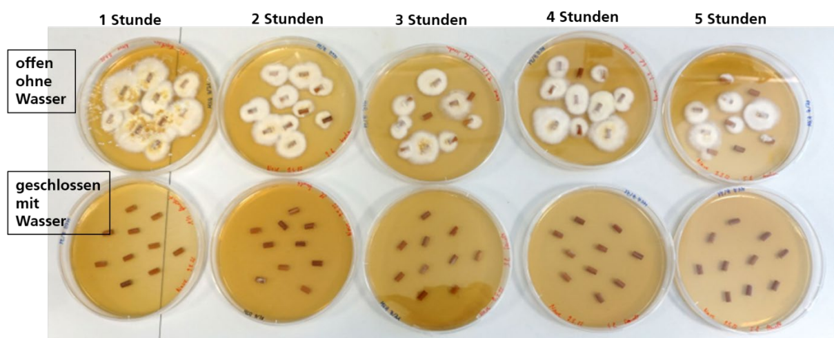
Abb. 5.4.13: Auf Agar über 7 Wochen reinkubierte Dübel nach der Erwärmung auf 60 °C im offenen Gefäß (oben) und mit Wasser im geschlossenen Gefäß (unten) über jeweils ein (links) bis fünf Stunden (rechts).
