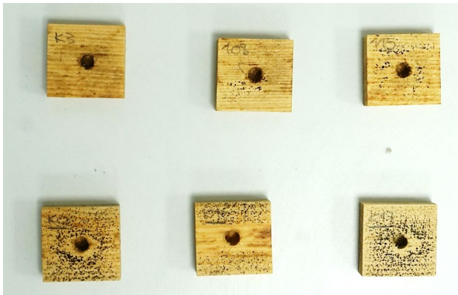
Abb. 5.4.27: Probekörperansicht jeweils dreier getrockneter Proben nach 36 Wochen Inkubationszeit aus dem Kurzfrist-Feuchtwechsel-Szenario Box 1 (oben) und Box 2 (unten).
