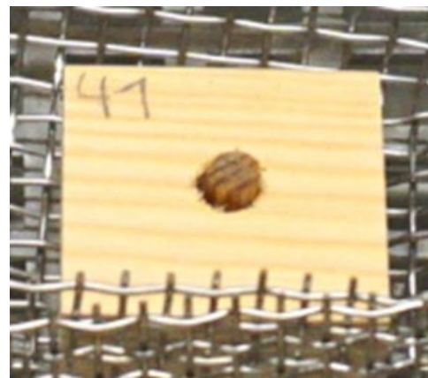
Abb. 5.4.5: Links: Mit Coniophora puteana infizierte Holzdübel. Rechts: Mit Dübel beimpfter Probekörper.
