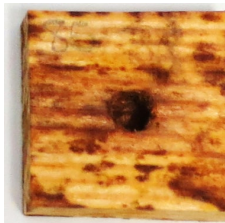
Abb. 5.4.21: Ansicht der getrockneten Probekörper aus den verschiedenen Versuchsszenarien sortiert nach aufsteigendem Masseverlust. Nur die ersten beiden Probekörper wurden mit Myzel, die übrigen mit Dübeln beimpft.
