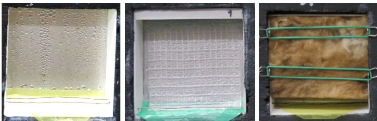
Abb. 5.5.2: Links: leerer Versuchsrahmen mit Tauwasser an der Metallplatte, Mitte: Tauwasser auf Folie mit Gewebestruktur, rechts: Folie auf Metallplatte fixierte Mineralwolldämmung.
