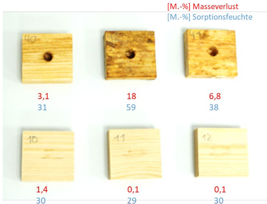
Abb. 5.4.11: Getrocknete Proben nach 12 Wochen langer Inkubation bei 25 °C und 100 % r.F.. Die Proben in der oberen Reihe wurden mit Dübeln, die unteren mit Myzelausschnitt beimpft. Die angegebenen Zahlen repräsentieren den ermittelten Masseverlust (rot) sowie Sorptionsfeuchte nach Entnahme (blau).
