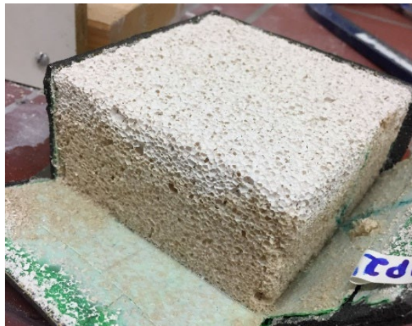
Abb. 5.6.9: Probe von Porenbeton am Ende der Messung, die feuchte Seite ist deutlich zu erkennen.
