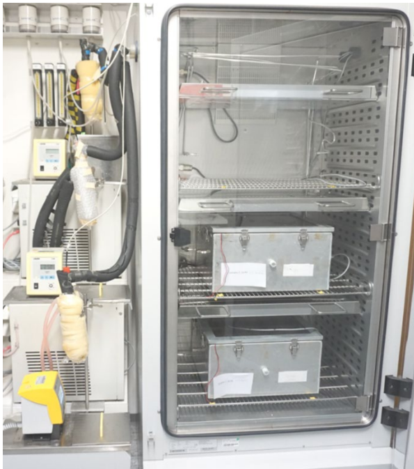
Abb. 5.4.6: Links: Inkubationsbox im Klimaschrank mit Anschlussmöglichkeit an die Feuchteregulierung. Rechts: Inkubationsbox mit beimpften Probekörpern.
