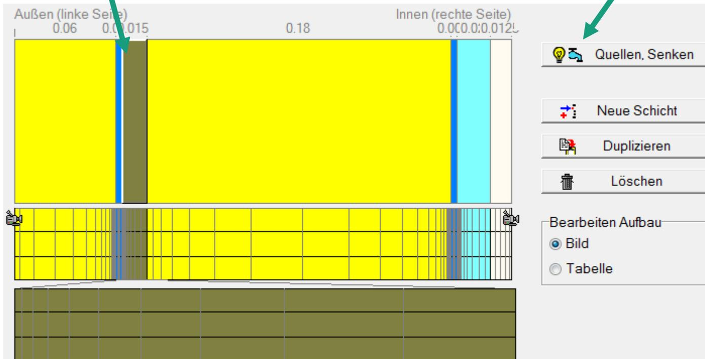
\*) Material, in/an dem Tauwasserausfall aufgrund von Konvektion zu erwarten ist. Infiltrationsquelle entweder in die inneren 5 mm der Schalung oder – wenn keine Schalung vorhanden – in die äußeren 5 mm der Zwischensparrendämmung
