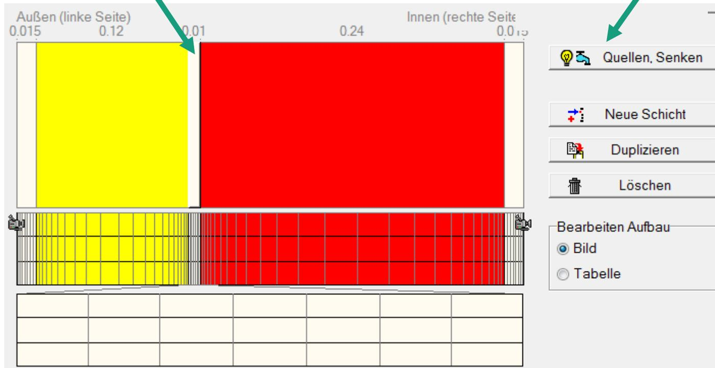
\*) Schlagregenquelle wird in die äußeren 5 mm der an das WDVS angrenzenden Schicht eingebracht.
