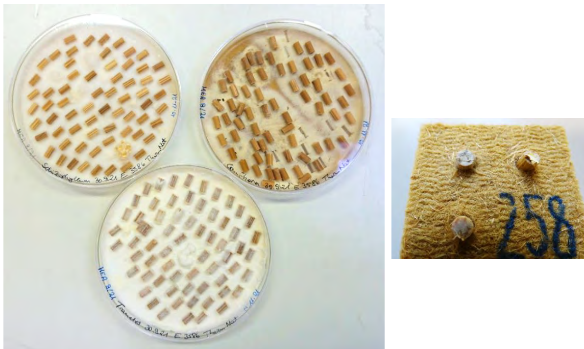
Abbildung 26: oben links - Vorbereitung von infizierten Holzdübeln (oben links: Schizophyllum commune , oben rechts: Coniophora puteana , unten: Trametes versicolor ) und rechts mit Dübeln „beimpften“ Probekörper.
