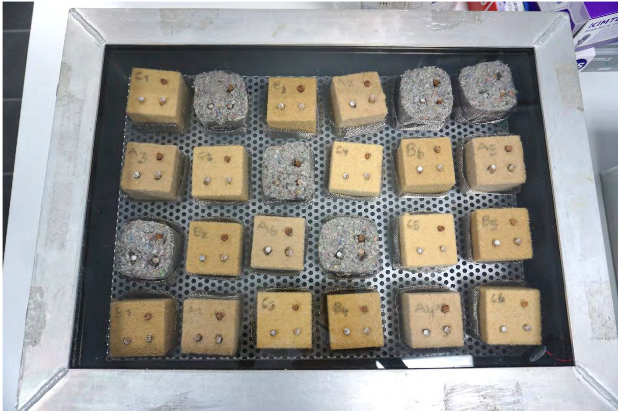
Abbildung 27: Inkubationseinheit mit beimpften Probekörpern. Unter dem Gitter befindet sich die mit Salzlösung bzw. destilliertem Wasser gefüllte Schale.
