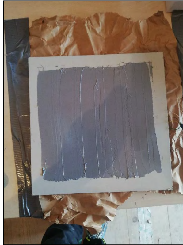
Abbildung 21: Wärmestromplatte mit aufgetragener Wärmeleitpaste ( \lambda = 6 \text{ W/mK} ).
