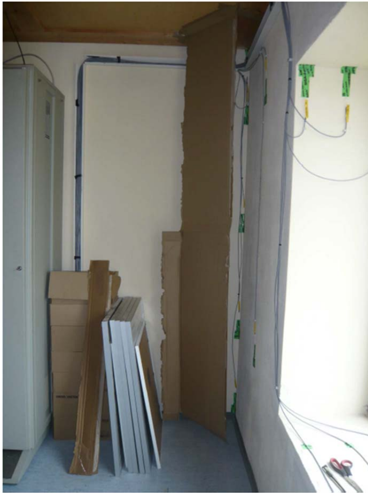
Bild 252: Für die Thermografieaufnahme aufgestellter Karton in der Raumecke aus [91].
