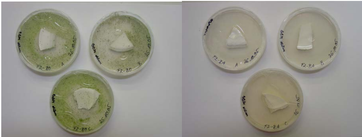
Bild 2: Beispiel für den Efficacy Test, links eine biozidfreie Kontrollvariante mit lebenden Algen am Schluss der Testdauer; rechts eine biozide Variante, die Algen sind am Schluss der Testdauer abgestorben.
