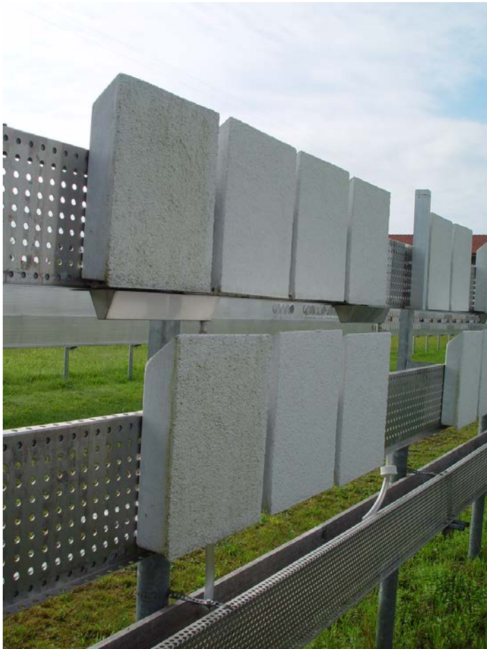
Bild 4: Bewuchs auf den Prüfkörpern mit mineralischem Putz und Dispersionsfarbe ohne Biozid (links) mit Biozid (rechts) im Juli 2007 in Holzkirchen.
