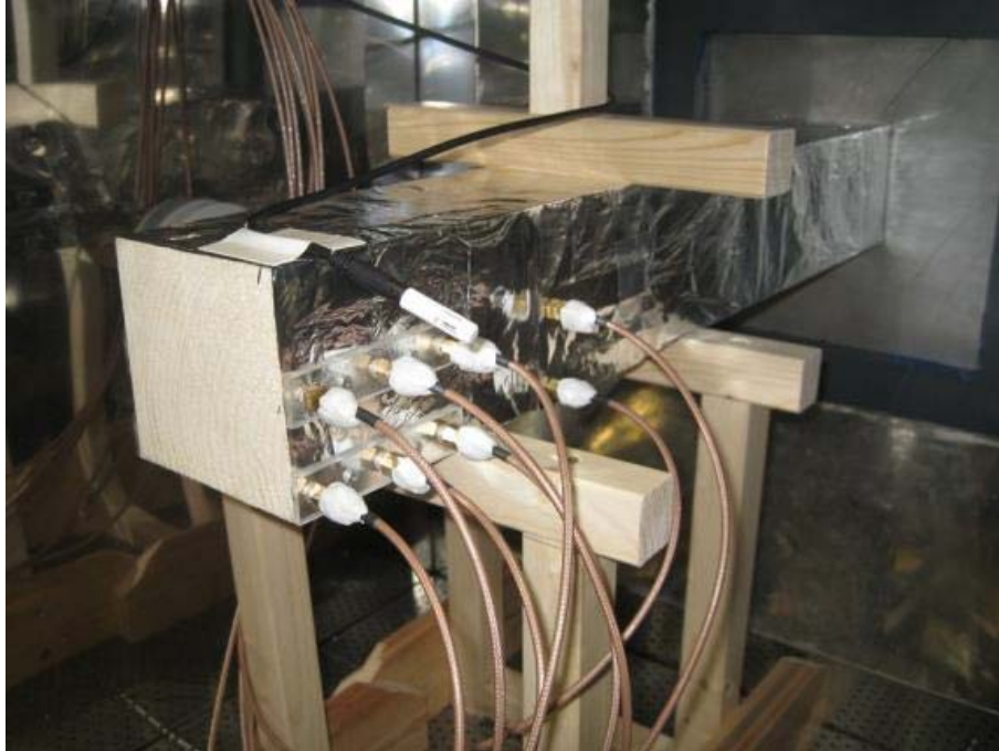
Abb. 161 Der Akademische Holzbalken in der Klimakammer in Vorbereitung für die Durchführung von Fall 1.
