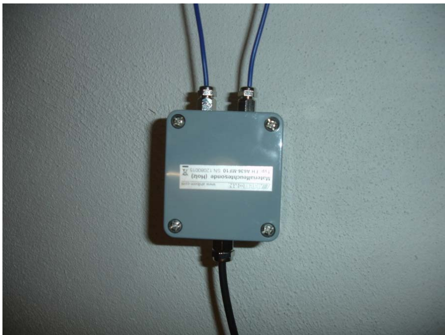
Abb. 79 Ansicht des pro Messstelle eingesetzten Holzfeuchtemessmoduls (Modell FHS 636 MFS1).
