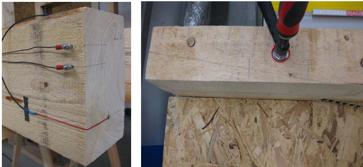
Abb. 113 Messung der Holzfeuchte und der Stirnholzoberflächentemperatur (BK, links), Vorbereitung für Einbringen des kombinierten Sensors im Stirnholzbereich (BKSH, rechts).
