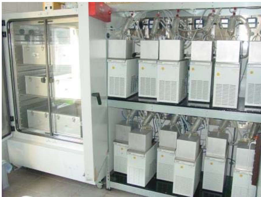
Abb. 189 Spezielle Versuchseinrichtung zur Bestimmung von produktspezifischen Isoplethenbereichen zur Charakterisierung der Resistenz gegenüber Schimmelbefall.
