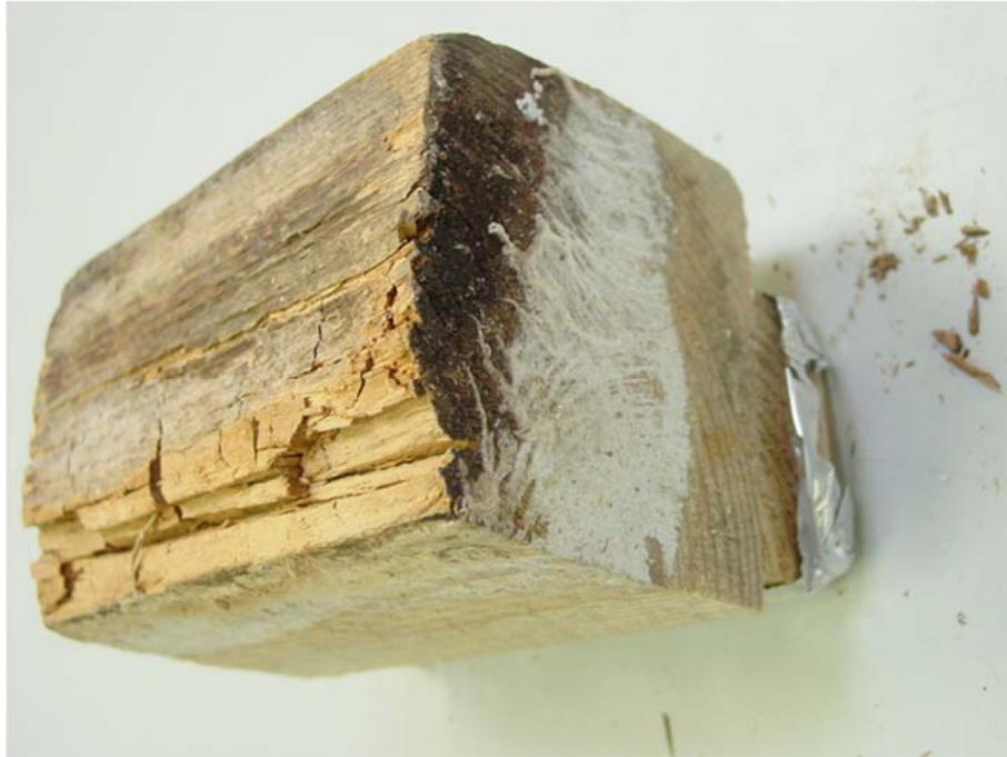
Abb. 1 Holzbalken mit Braunfäuleerreger Coniophora sp.
