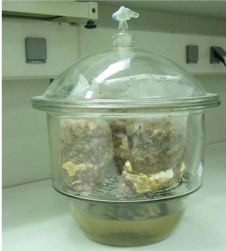
Abb. 194 Mit Coniophora puteana (Kellerschwamm) beimpfte Holzspäne.
