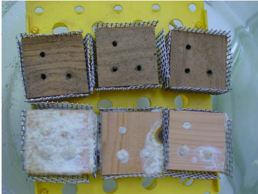
Abb. 192 Wachstum bei 98-100 % Luftfeuchtigkeit und 23 °C Temperatur.
