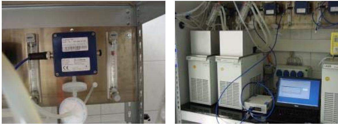
Abb. 190 Messung der metabolischen Aktivität mittels CO 2 -Sensoren.
