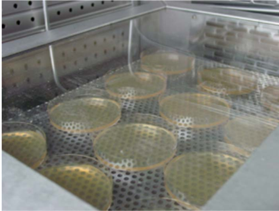
Abb. 199 Erweitertes Setup: Testlauf mit beimpften Agarplatten.
