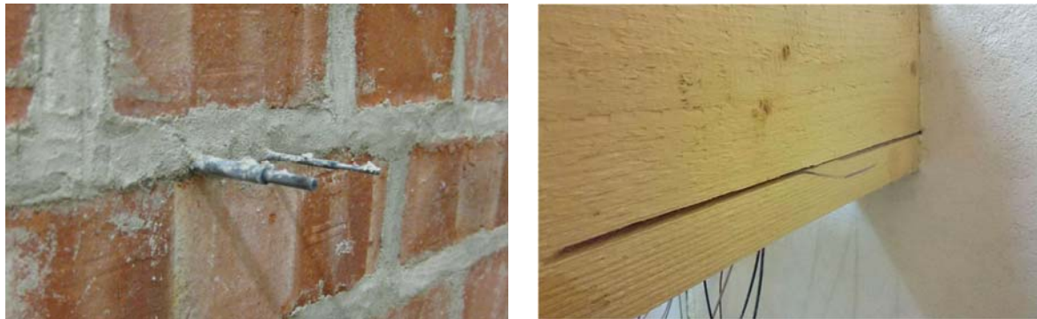
Abb. 117 Röhrchen zur Erzeugung gewollter Undichtigkeiten (links) und verschließbare Nut als idealisierter Riss (rechts).
