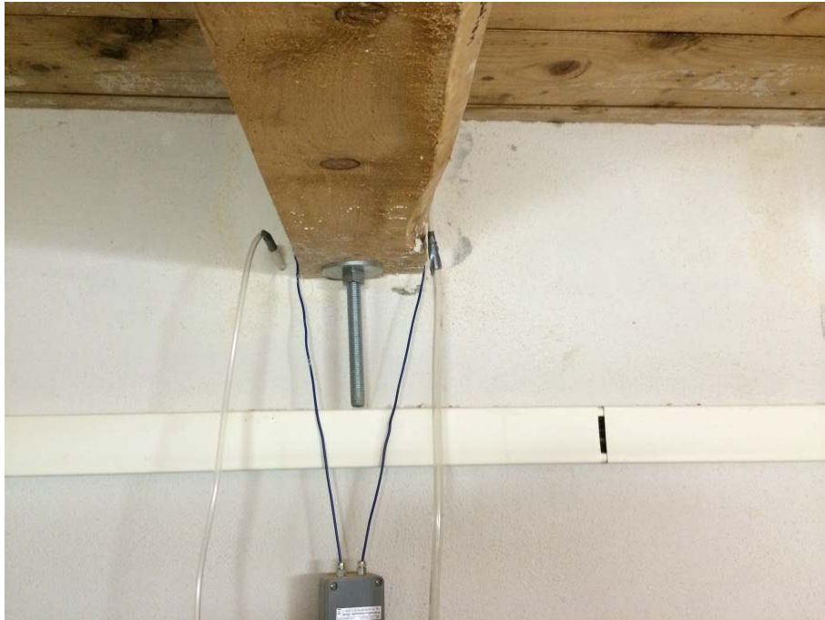
Abb. 76 Ansicht der Ausführung des Balkens 5 im Raum 1 mit erzwungener „Konvektion“ durch eine Membranpumpe.
