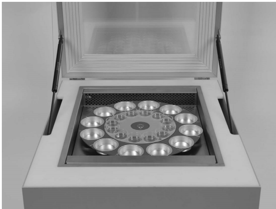
Abb. 88 Tischgerät mit großem Probendurchsatz zur rationalen Bestimmung des sorptiven Verhaltens von Baustoffen gegenüber Wasserdampf.
