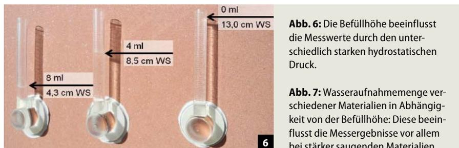
**Abb. 6:** Die Befüllhöhe beeinflusst die Messwerte durch den unterschiedlich starken hydrostatischen Druck.
