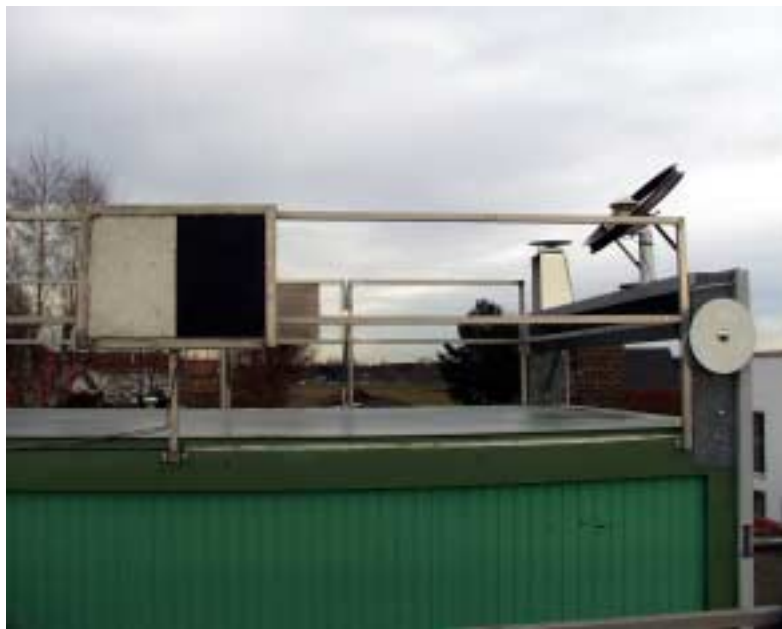
Bild 3: Nach Westen exponierte, rückseitig wärmedämmte Prüfflächen, deren Oberflächentemperaturen im Rahmen der meteorologischen Datenerfassung kontinuierlich gemessen werden
