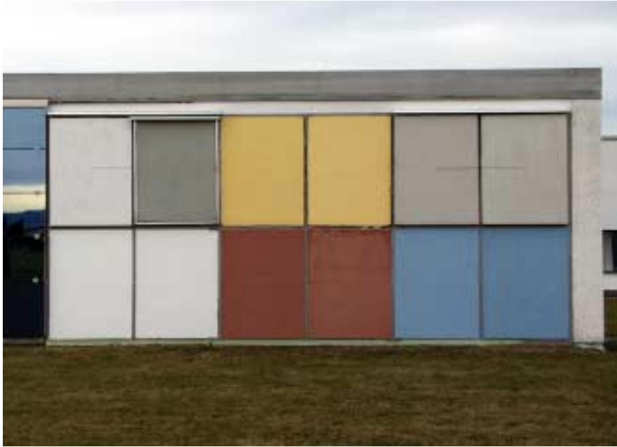
Bild 8: Nach Süden orientierte Testfassade eines ca. 4 m hohen beheizten Versuchsgebäudes zur energetischen Beurteilung unterschiedlicher Außenwandausschnitte. Die grauen Zwillingsfelder rechts oben sind als WDVS mit und ohne infrarot-reflektierendem Anstrich ausgeführt.
