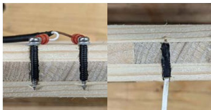
Abb. 4: Beispielhaft im Schnitt dargestellt: Links: Schraubelektroden mit isoliertem Schaft zur Messung im Holzkern. Rechts: Pt100-Temperaturfühler mit Flachbandkabel im Bohrloch verklebt, um die exakte Temperatur an der Messposition zu erfassen. Bildquelle: TimberTrack®
