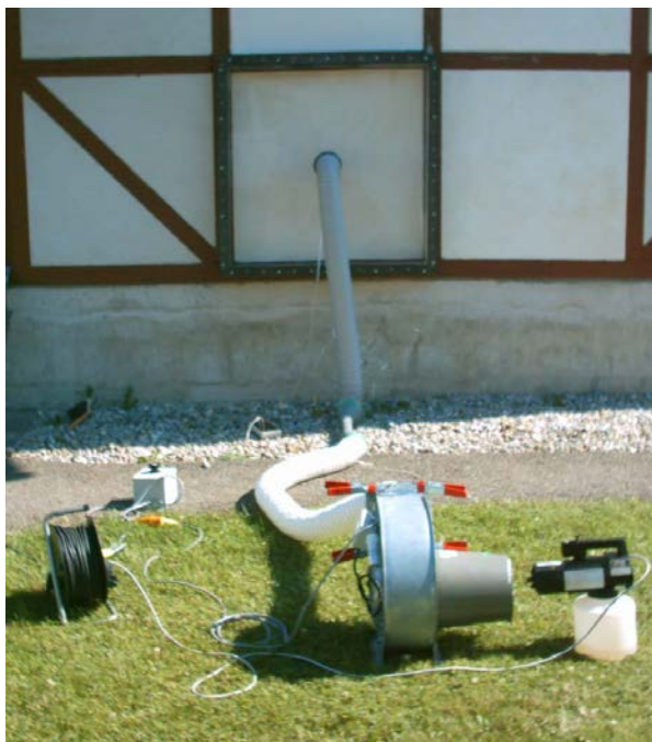
Bild 8: Darstellung des kompletten Versuchsaufbaus zur Ermittlung der Luftdichtheit der einzelnen Varianten.
