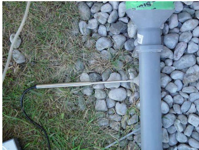
Bild 7: Detail der Strömungsmessung mit Hilfe eines Hitzdrahtanemometers in der Messstrecke der Versuchseinrichtung.
