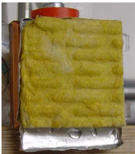
Bild 9: Rückwärtig unterkühlte Mineralwolleprobe mit Tauwasser. Mineral wool specimen cooled from the back side.
