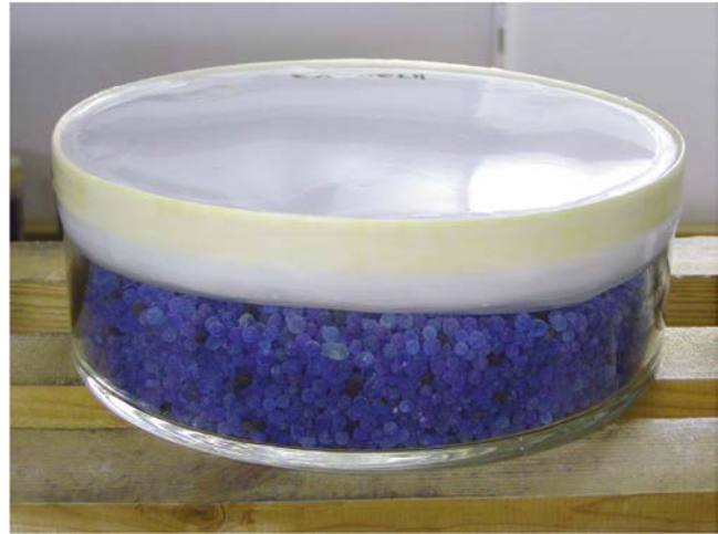
Bild 1 Die zu messende Folie ist über eine mit Trockenmittel gefüllte Schüssel gespannt und seitlich abgedichtet The membrane to be measured is sealed across the mouth of a cup filled with drying agent
